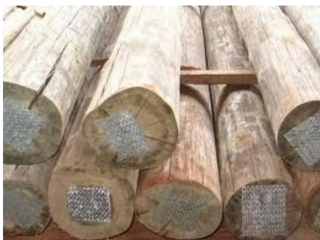
Eucaliptos autoclavados (envenenamento no cerne da madeira)
