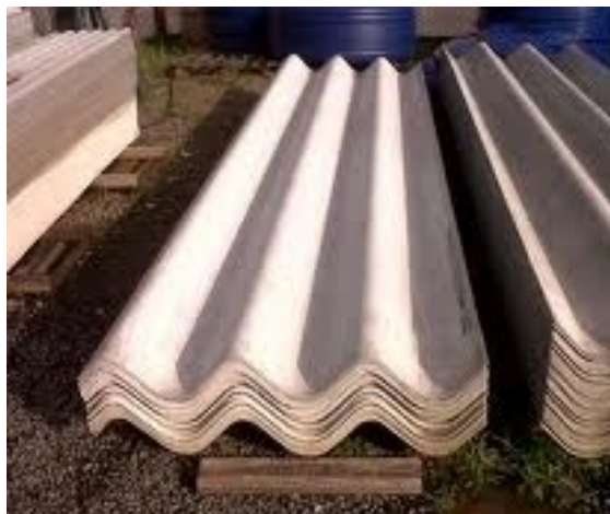
Telhas de fibrocimento sem amianto (boa durabilidade)
