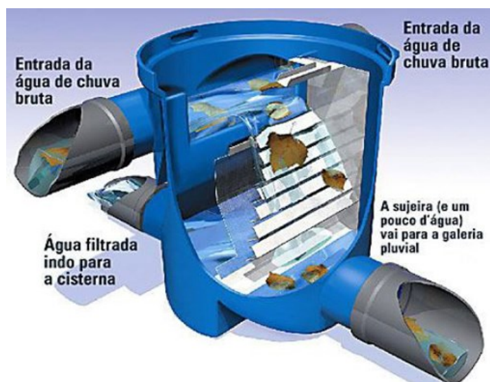
Filtro VF1 - detalhes
