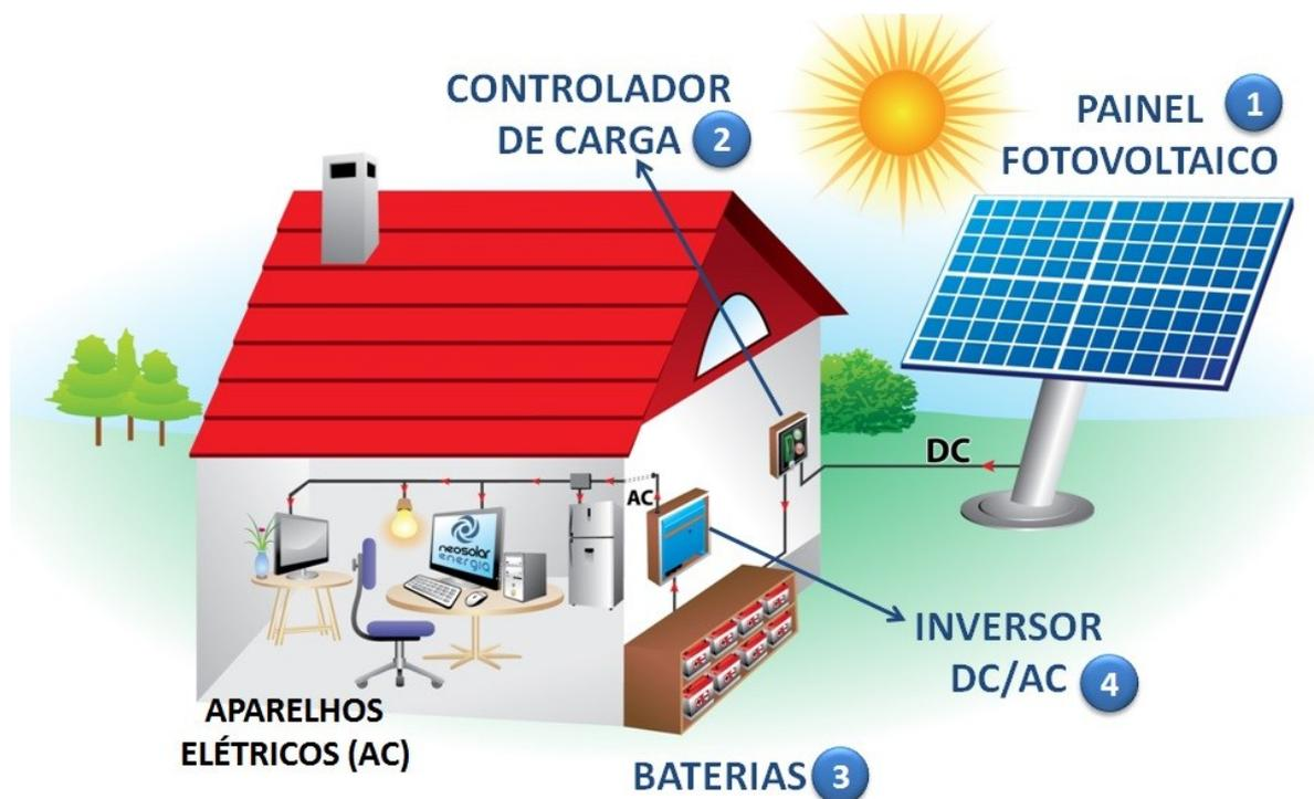
Detalhe – funcionamento energia fotovoltaica
