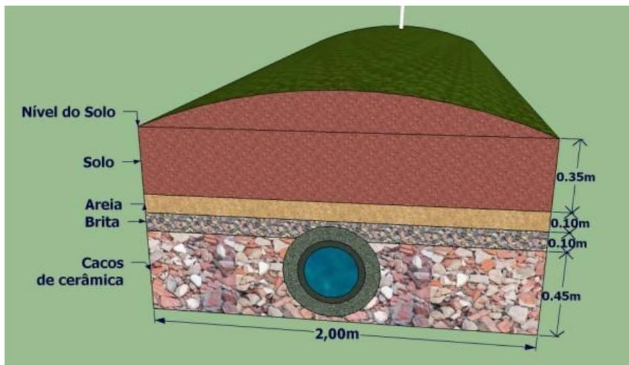
Corte – Tanque Evapotranspiração
