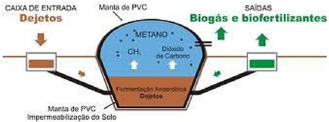
Modelo de Biodigestor subterrâneo
