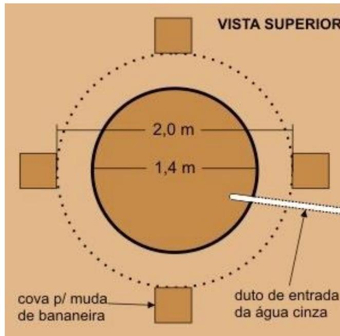
*A água cinza deve ser conduzida por um tubo até o buraco e com um joelho na ponta para evitar o entupimento. Não usar valas abertas para a condução da água, assim mosquitos e outros animais indesejados não terão como se desenvolver. E os microrganismos da compostagem terão um ambiente perfeito para fazer o seu trabalho.”*
