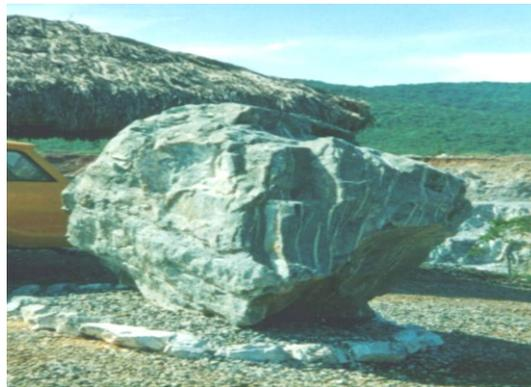
Pedra de amianto ou asbesto bruto com sua parte fibrosa (branca acinzentada), que é comercialmente aproveitada.
