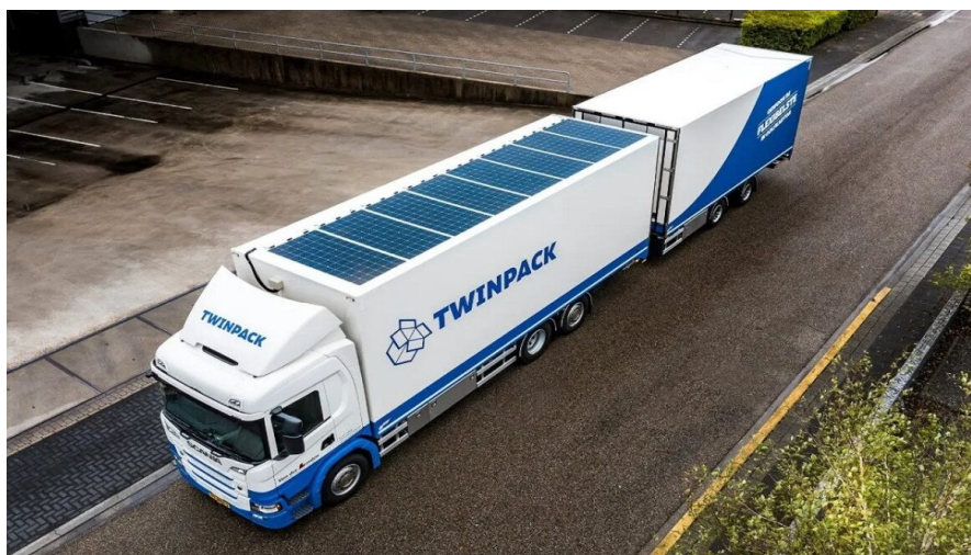
Caminhão Scania – painéis fotovoltaicos no teto
