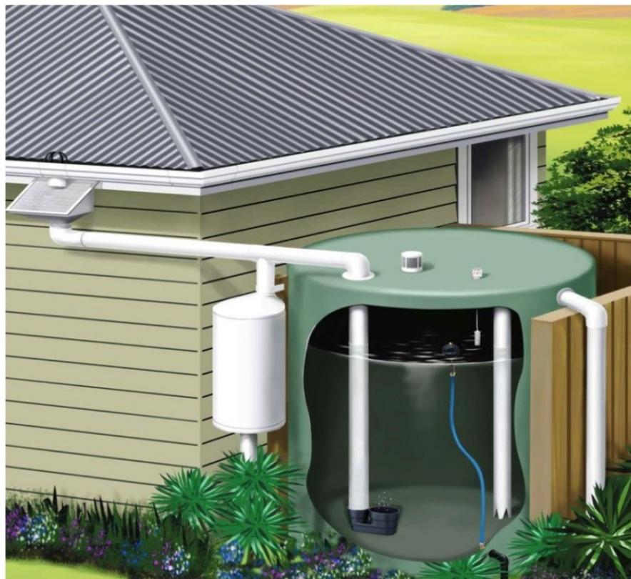
O filtro VF1 (peça de plástico - cor branca) retém a chamada 1° água da chuva, liberando para dentro da cisterna a água que vem a seguir
